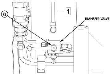
TRANSFER VALVE LEVER, CLOSED POSITION SHOWN 0007 00-3
